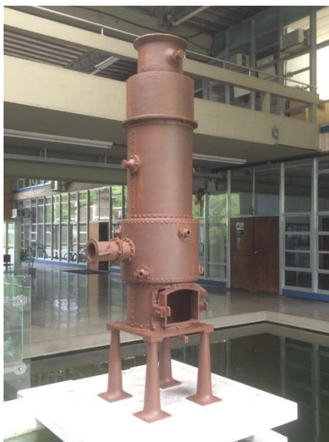
Imagem 5 – Forno Cubilot presente no Departamento de Engenharia Metalúrgica e de Materiais da Escola Politécnica de São Paulo
